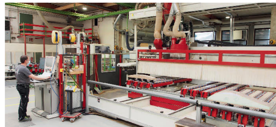
Eines von zwei leistungsfähigen CNC-Bearbeitungszentren aus dem Hause Ima ist die Tandemaschine PX 80. Die Maschine hat 86 Werkzeuge an Bord und bietet reichlich Bearbeitungshöhe in Z-Richtung.
